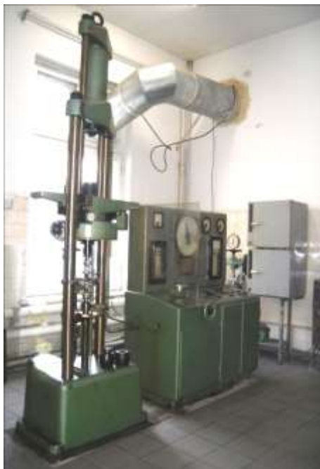
Рис.2. Опытный трубчатый образец с приспособлением измерения деформаций установленный на испытательной машине ZDMU-30T.
