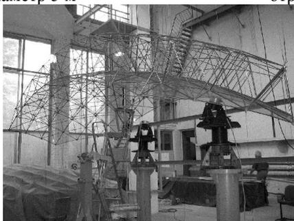
Рис.3 Параболический рефлектор ферменного типа
