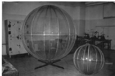
Рис. 2. Космический сферический отражатель
