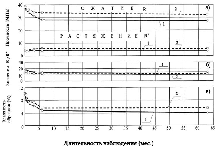
**Рис.** Диаграммы изменения влажности (в), прочностей при сжатии и растяжении (а) литоидпемзобетона и значения их отношений (б) в зависимости от продолжительности процесса десорбции влаги.
